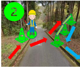
②駐車場入口付近（横断部分にはコーン設置）
